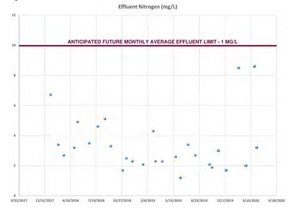
Figure 7-6. WWTP Historical Effluent TN
